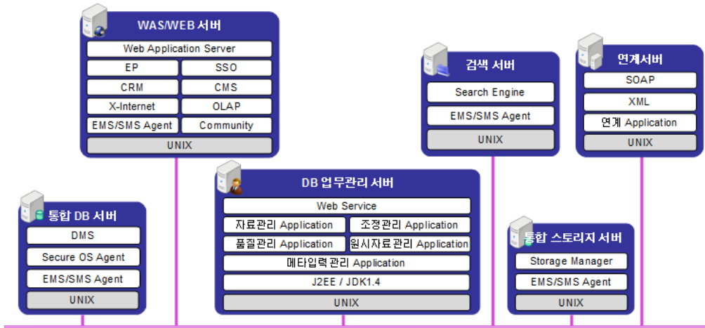
[그림 IV-46] 시스템 소프트웨어 구성도
